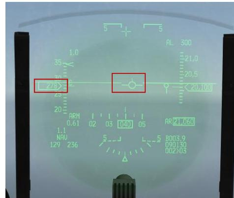
10% Schubänderungen wirken sich kaum aus! Und dies, obwohl oder gerade weil der Stick bei dieser Geschwindigkeitsänderung vollkommen ausgelassen wurde, es gab also keinen Pitch Input. Wie kann dies möglich sein? Mehr Schub bewirkt doch mehr Auftrieb, die F-16 sollte also mehr steigen und umgekehrt sinken - warum tut sie dies nur andeutungsweise?
