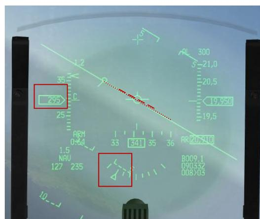
Nun hat der Pilot seinen Fehler erkannt, und leicht am Stick nach hinten gezogen **und diesen Zug gehalten**. Dadurch verwendet er mehr Auftrieb für die Beibehaltung der Höhe, zwingt ja nach wie vor die F-16 auf 30° Bank zu fliegen, aber verliert dadurch stark an Geschwindigkeit. Er muss nun den **Schub anpassen!**
