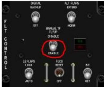
Der MANUAL TF FLY UP Schalter auf dem FLCS Panel muss auf ENABLE geschaltet werden. Wie alle anderen Schalter auf diesem Panel auch steht er damit in der „down“ Position. Dies mit einem Blick auf das FLCS Panel zu überprüfen sollte zur guten Angewohnheit werden!
