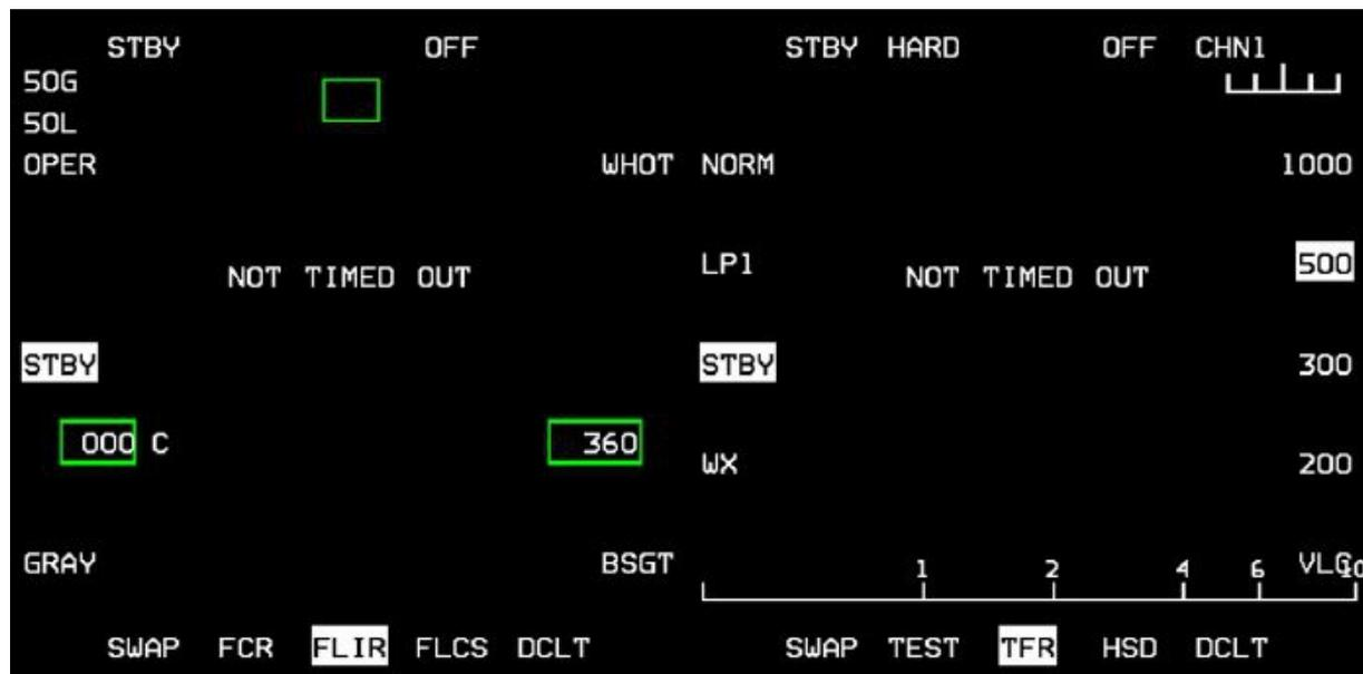
Für die TFR Checks ist es Voraussetzung, dass der RF Schalter auf NORM steht da ansonsten nicht alle Modi zur Verfügung stehen.
