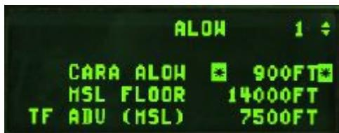
Mittels des ICP wird anschließend die A-LOW Taste (2) die CARA ALOW standardmäßig auf einen Wert von 10% unterhalb der (set clearance plane) gesetzt => hier also SCP-10% = 900 ft
